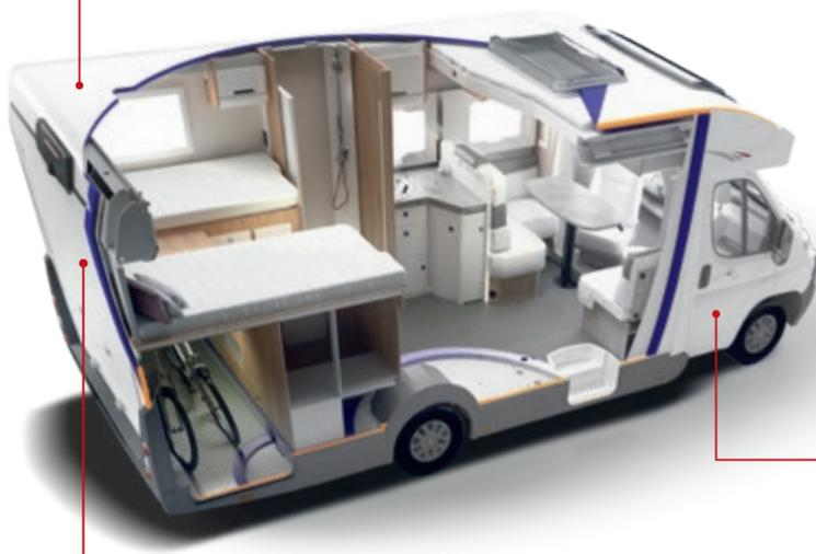
**SEITENWÄNDE.** Hagelfester GFK außen. Interne Struktur aus wasserfestem PS-Material. Der umlaufende Schutz aus hochdichtem Kunststoffmaterial verhindert jeglichen Kontakt zwischen innen und außen und verhindert so das Eindringen von Wasser in die Wände. **Innenwände aus Glasfaser**, beständig gegen Feuchtigkeit und keine Wärmebrücken, die zumeist die Ursache für Kondensation oder Wärmeverlust sind.
